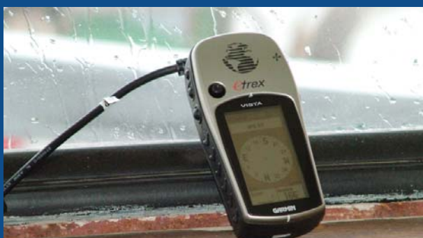
ETrex Vista kao heading senzor
